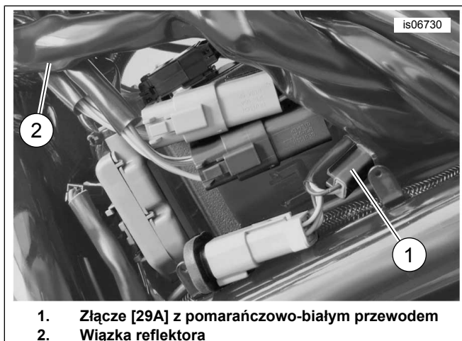
Rysunek 29. Miejsca łączenia przewodów (modele V-Rod z roku 2004)
