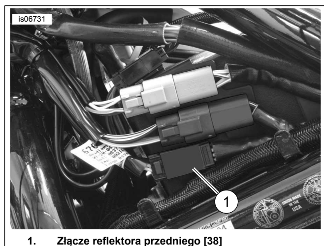
Rysunek 30. Miejsca łączenia przewodów (modele V-Rod z roku 2005 i lat późniejszych)
