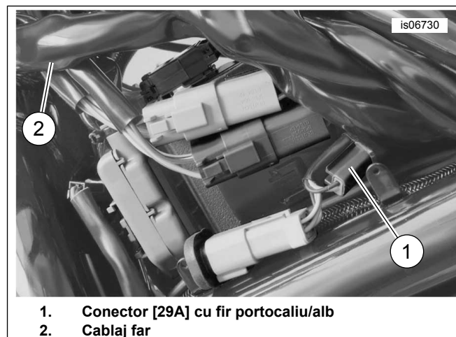
Figura 29. Locurile de îmbinare fire (2004 V-Rod)
