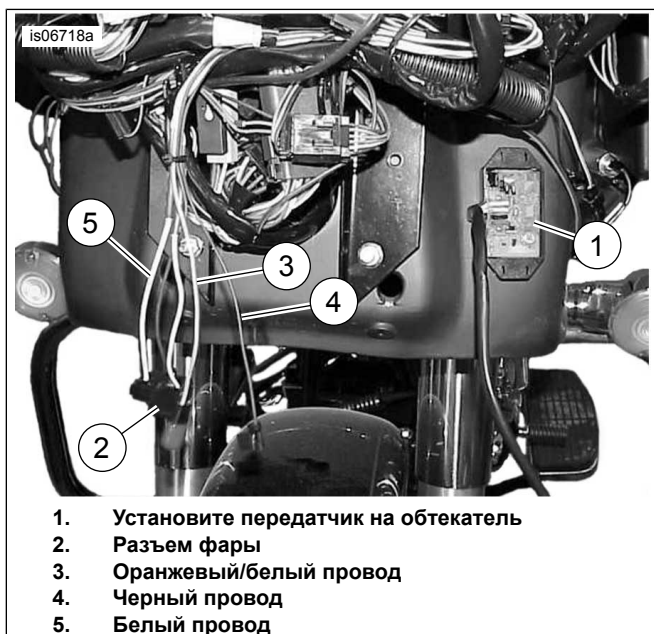
Рисунок 12. Провода для подключения передатчика (модель FLTR 2013 и более ранних годов выпуска)
