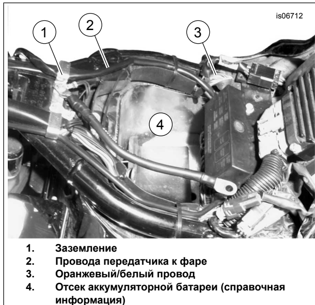
Рисунок 6. Подключение к источнику питания и заземление, модель Softail 2000–2017 годов выпуска (показана модель FLSTC)
