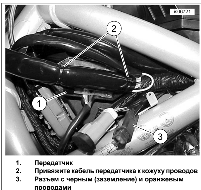
Рисунок 18. Установка передатчика (только модель V-Rod 2002–2003 года выпуска)
