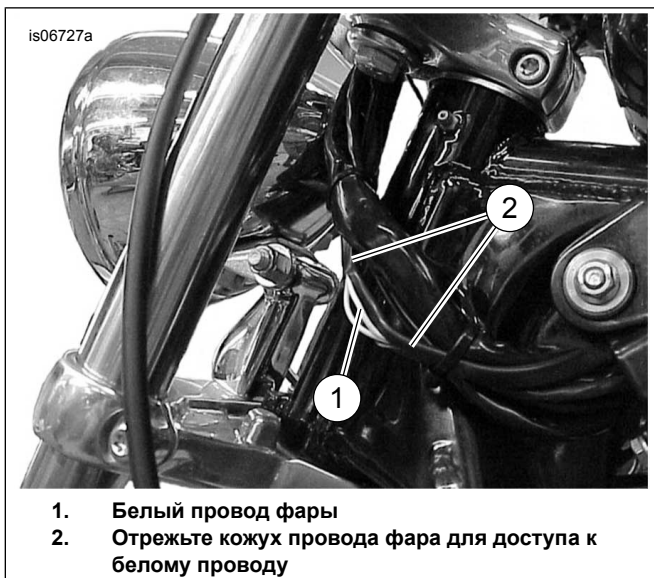
Рисунок 32. Место для дополнительного внешнего срачивания белого провода (модели Sportster)
