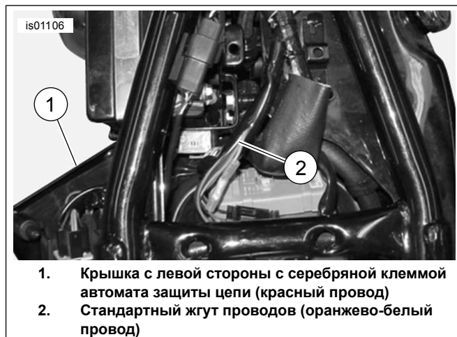
Рисунок 27. Подключение к источнику питания (модели Sportster)
