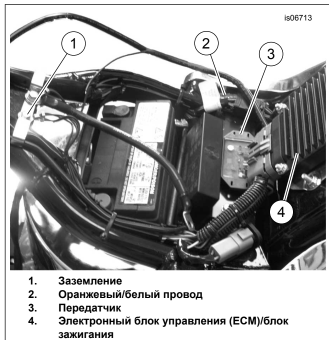
Рисунок 7. Установка передатчика (модель Deuce)
