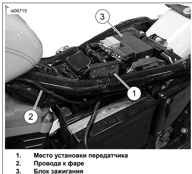
Рисунок 8. Установка передатчика и прокладка проводов (модель Sportster 2003 и более ранних годов выпуска)
