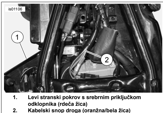
Slika 27. Napajalni priključki (modeli Sportster)
