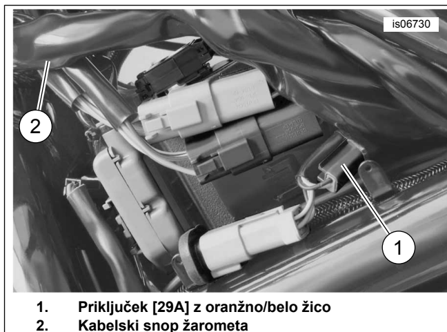
Slika 29. Lokacije žičnih spojev (V-Rod 2004)
