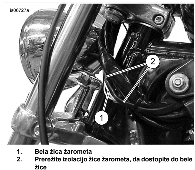
Slika 32. Mesto opsijske zunanje spojke bele žice (modeli Sportster)
