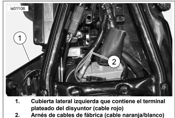
Figura 27. Conexiones de alimentación (modelos Sportster)
