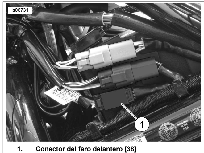
Figura 30. Ubicaciones del empalme de los cables (V-Rod de 2005 y posteriores)
