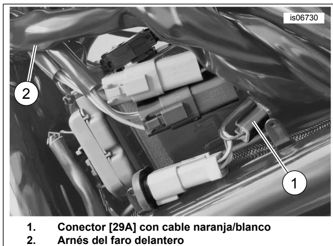
Figura 29. Ubicaciones de empalme de cables (V-Rod de 2004)
