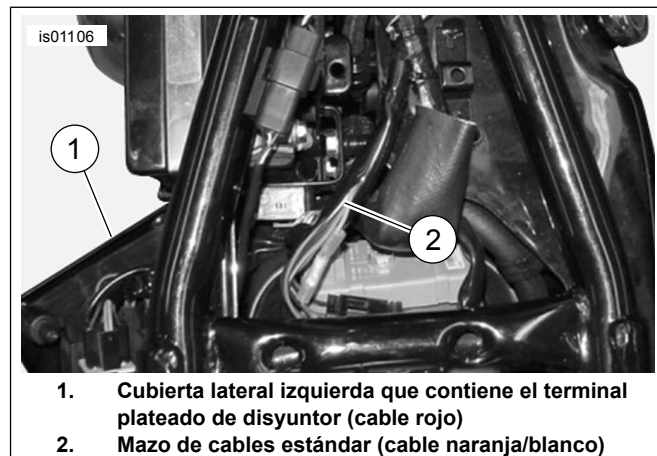
Figura 27. Conexiones de alimentación (modelos Sportster)
