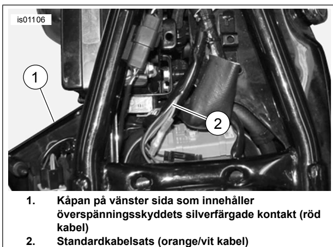
Figur 27. Elanslutningar (Sportster-modeller)
