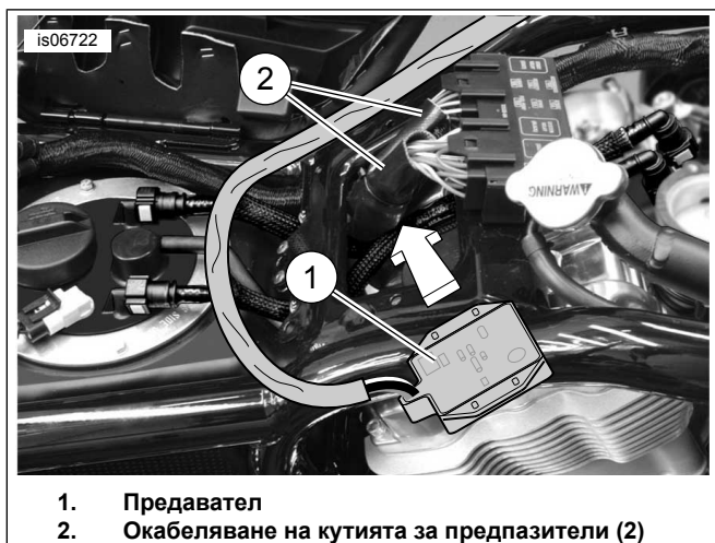
Фигура 19. Монтиране на предавател (модел V-Rod 2004 г. и по-нови)
