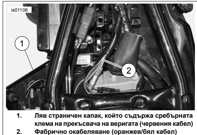
Фигура 27. Захранващи връзки (модели Sportster)
