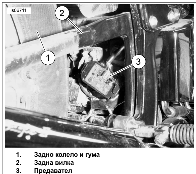
Фигура 5. Монтиране на предавател, модели Softail 2000-2017 г., освен Deuce (показан FLSTC)
