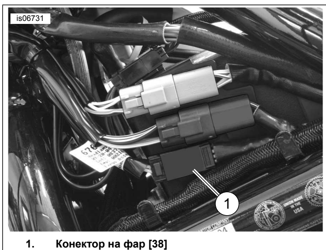
Фигура 30. Места за снаждане на проводници (V-Rod 2005 г. и по-нови)
