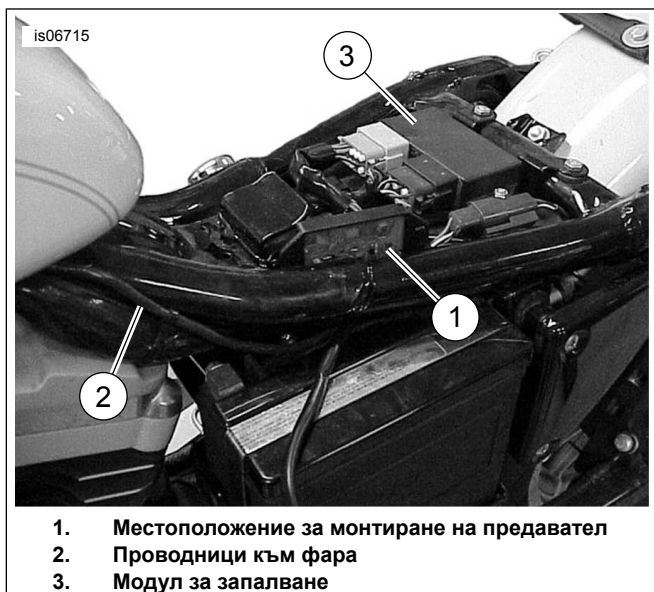
Фигура 8. Монтиране на предавател прекарване на окабеляване (моделите Sportster 2003 г. и по-стари)
