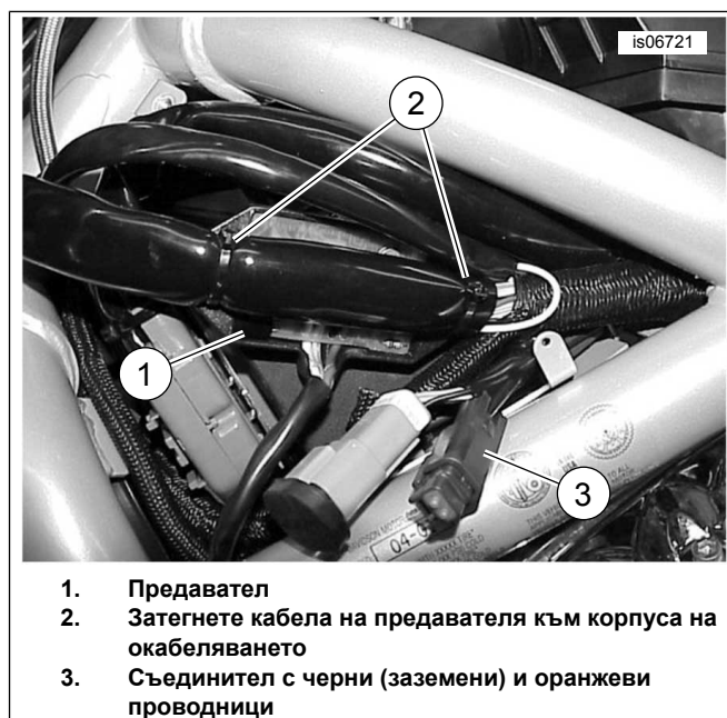
Фигура 18. Монтиран на предавател (Само за модели V-Rod 2002 г.-2003 г.)
