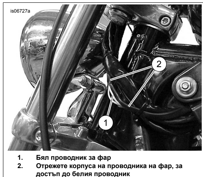
Фигура 32. Външно незадължително местоположение за снаждане на бял проводник (модели Sportster)
