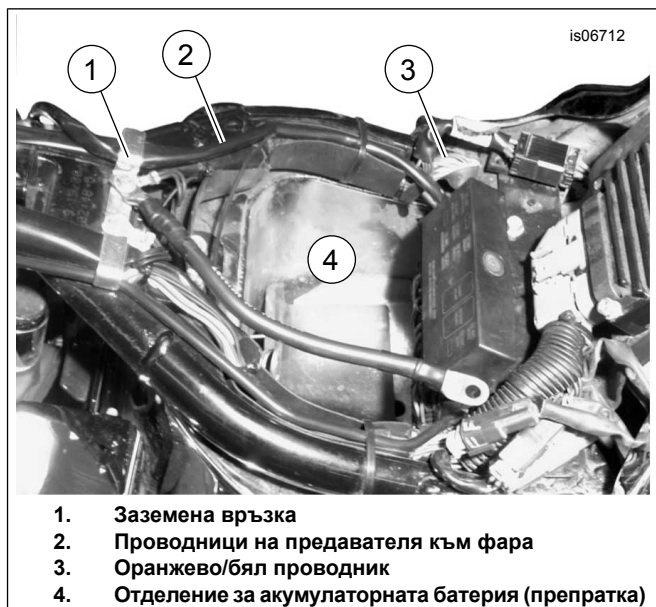
Фигура 6. Захранващи и заземителни връзки, модели Softail 2000-2017 г. (показан FLSTC)
