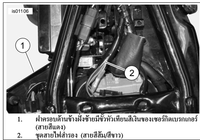
รูปภาพ 27 การเชื่อมต่อกับแหล่งพลังงาน (รุ่น Sportster)
