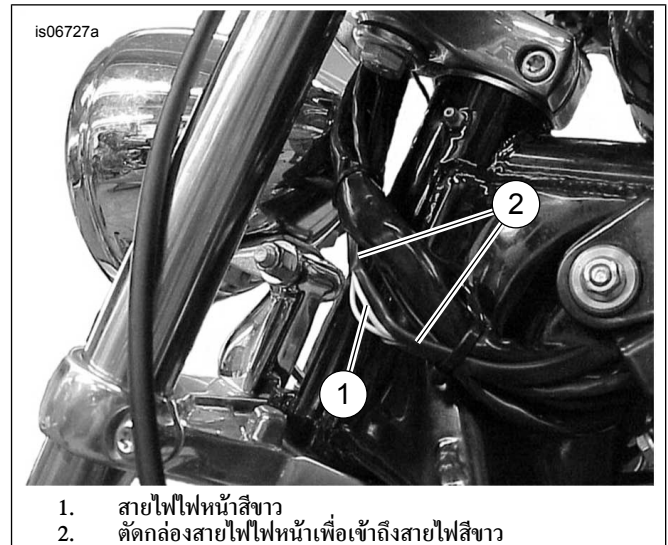
รูปภาพ 32 ตำแหน่งการประกบสายไฟสีขาวด้านนอกอีกตำแหน่งหนึ่ง ที่เลือกได้ (รถรุ่น Sportster)
