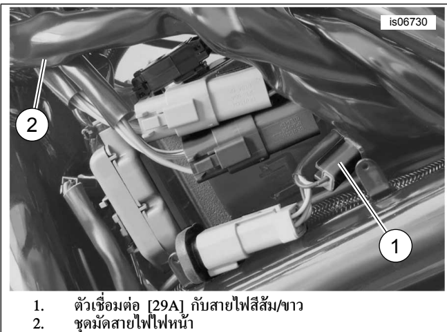
รูปภาพ 29 ตำแหน่งประกบสายไฟ (V-Rod ปี 2004)
