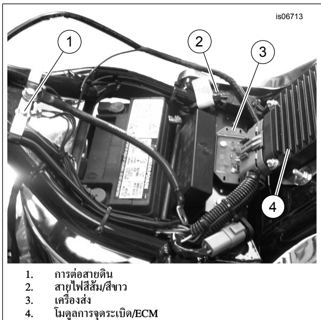
รูปภาพ 7 การยึดเครื่องส่งสัญญาณ, รุ่น Deuce
