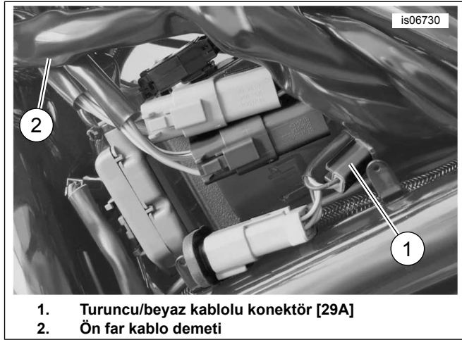
Şekil 29. Kablo Bağlama Konumları (2004 V-Rod)
