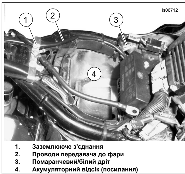
Малюнок 6. Електричні та наземні підключення, моделі Softail 2000-2017 рр. (показано FLSTC)
