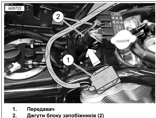
Малюнок 19. Монтаж передавача (моделі V-Rod 2004 року і пізніші)
