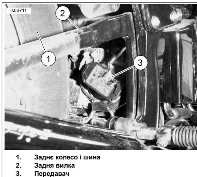
Малюнок 5. Монтаж передавача, моделі Softail 2000-2017 рр. за винятком Deuce (показано FLSTC)
