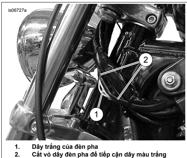
Hình 32. Vị trí nối dây màu trắng bên ngoài tùy chọn (các mẫu xe Sportster)
