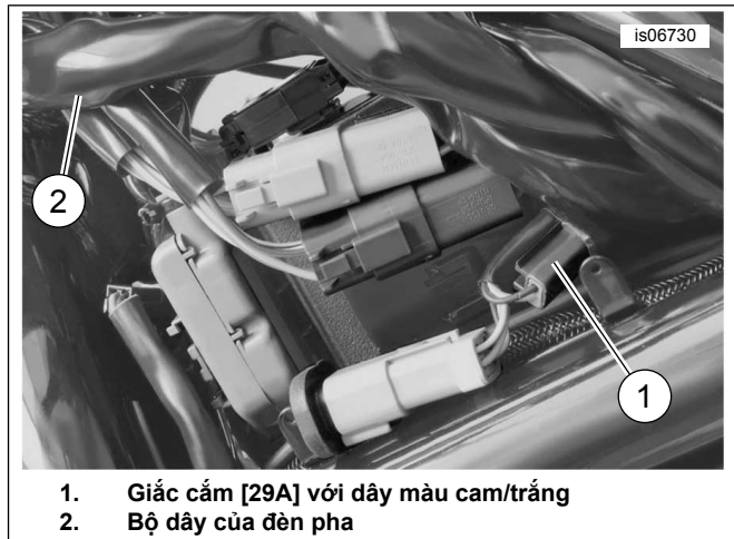
Hình 29. Vị trí nối dây (Mẫu xe V-Rod 2004)
