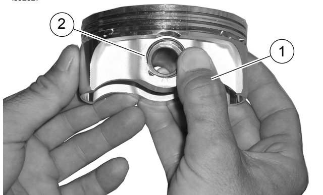
Ilustrace 4. Montáž pojistného kroužku
