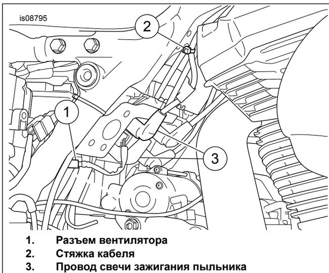
Рисунок 1. Разъем вентилятора
