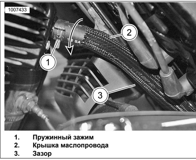
Рисунок 3. Крышка заднего маслопровода
