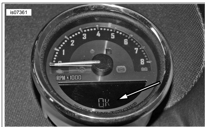
Afbeelding 3. De snelheidsmeter geeft 'OK' weer
