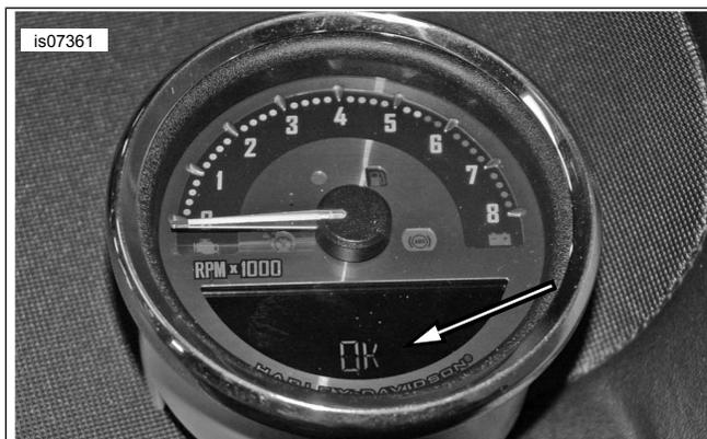
Abbildung 3. Die Tachometeranzeige zeigt OK
