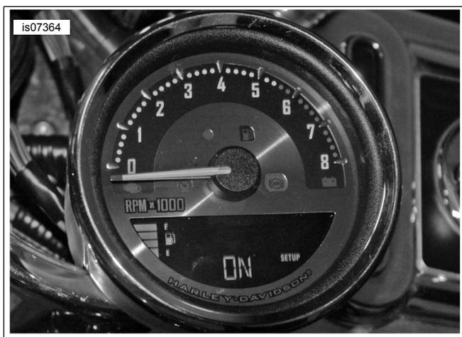
Abbildung 5. Vorbereitung der Kraftstoffstandanzeige
