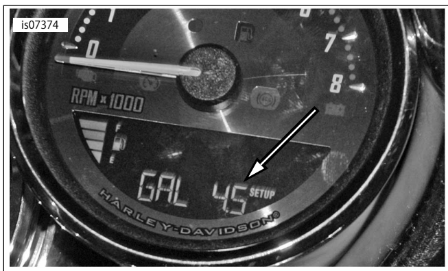
図6. フューエルタンクのサイズ選択 (Sportsterモデルのみ)
