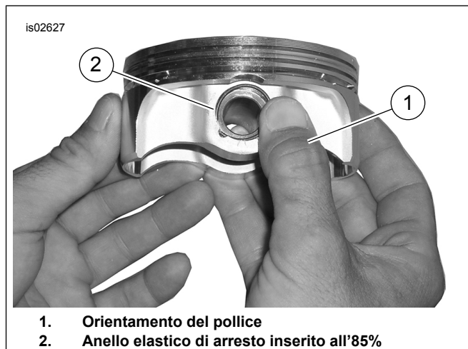
Figura 4. Installazione dell'anello elastico d'arresto
