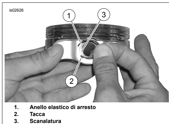
Figura 3. Anello elastico d'arresto e pistone
