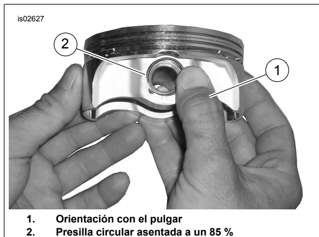
Figura 4. Instalación de la presilla circular
