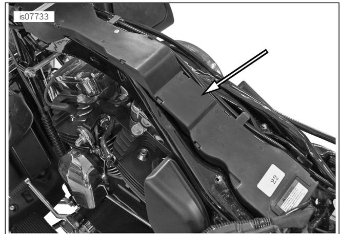
圖1。電線槽
