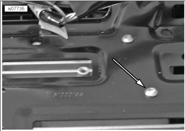
圖4。無線電支撐托架螺絲
