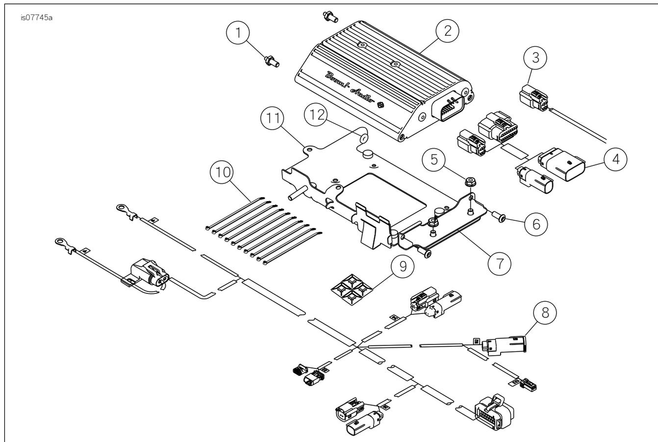
圖11。維修零件，Boom! Audio 擴音器工具包
