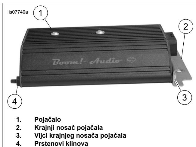
Slika 5. Prstenovi klinova pojačala i krajnji nosač pojačala
