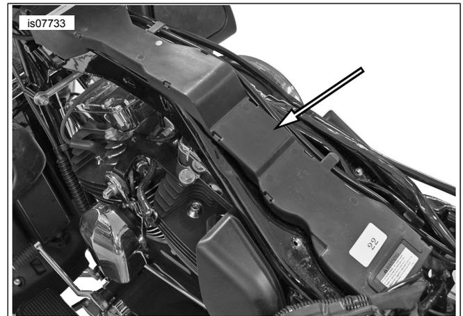
Abbildung 1. Kabelschacht
