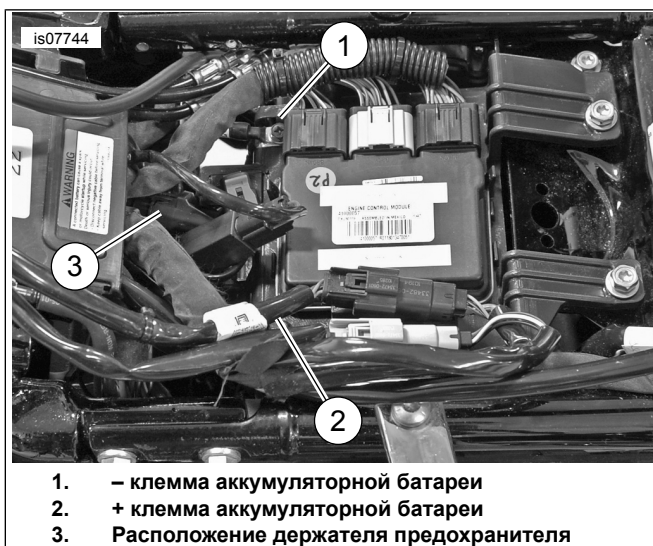
Рисунок 9. Подключение аккумуляторной батареи
