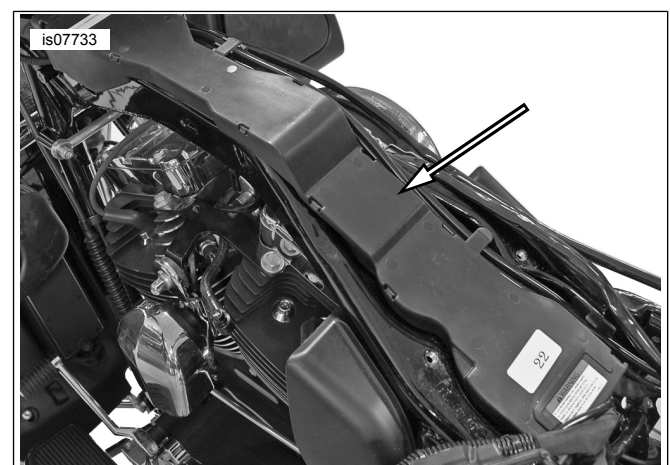
Figura 1. Canal de cables
