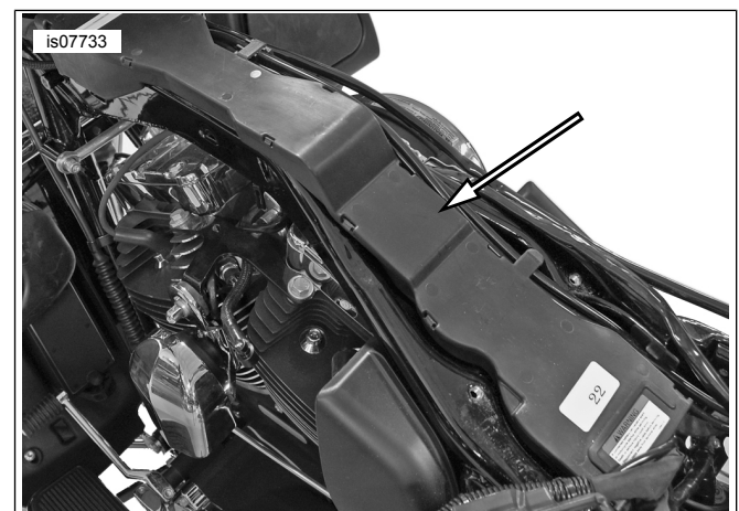
Figura 1. Calha de fios
