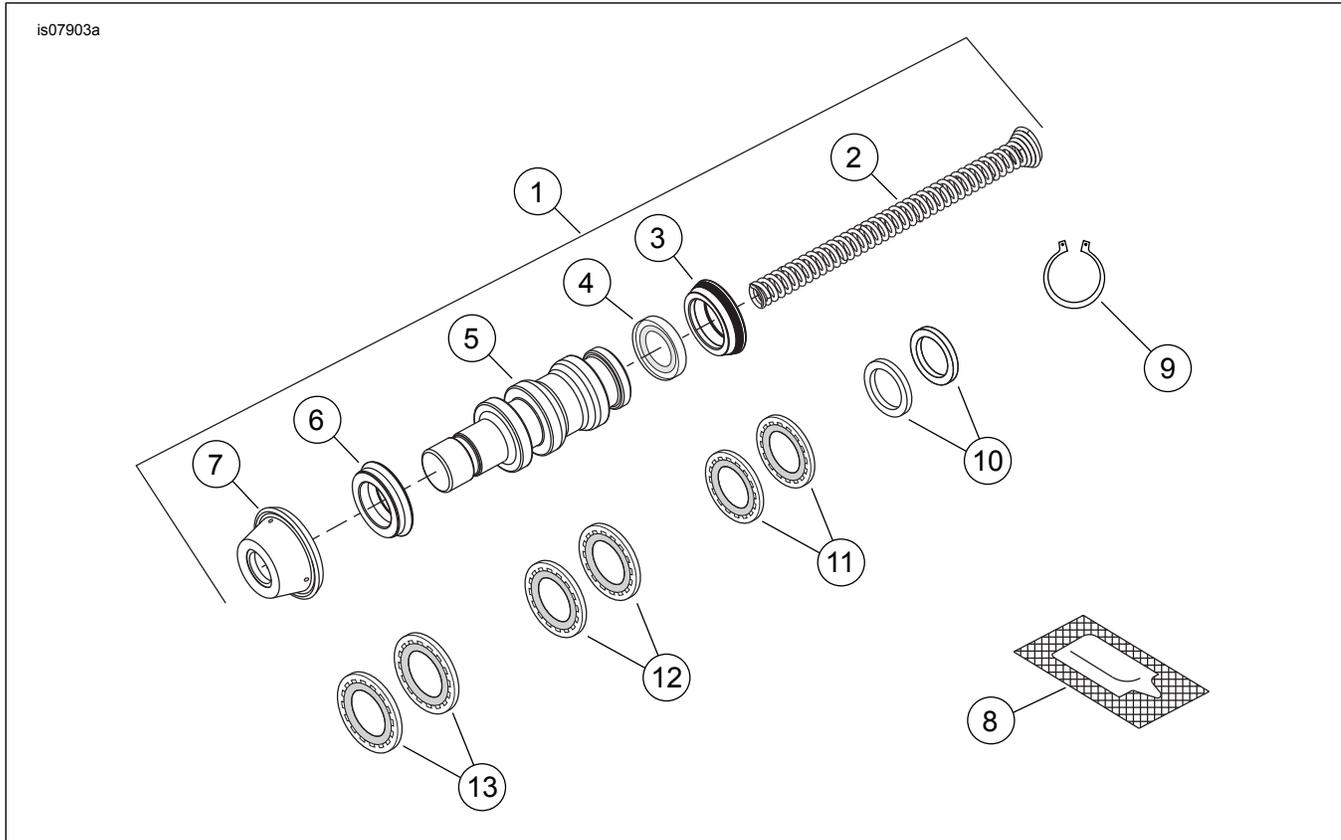
Figura 2. Parti di ricambio: Kit ricostruzione pompa della frizione
