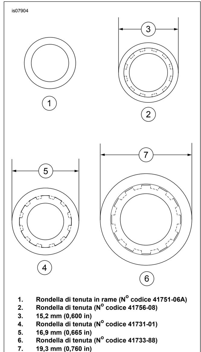
Figura 1. Rondelle di tenuta
