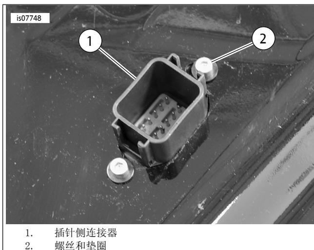
图3。插针侧连接器
