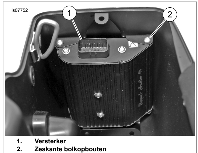
Afbeelding 7. Installeren van de versterker
