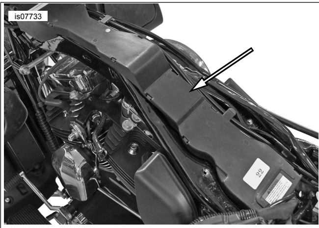
Figura 1. Calha de fios
