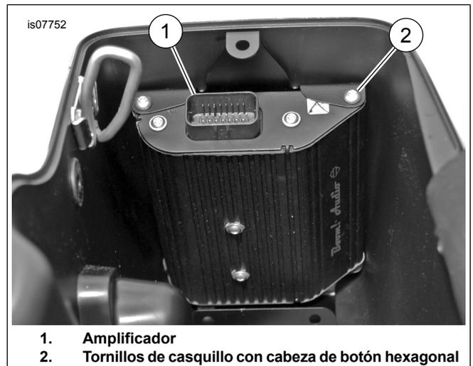
**Figura 7. Instalación del amplificador**
