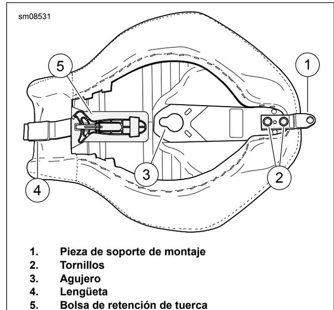
Figura 1. Pieza de soporte, tornillos, ranura de asentamiento y lengüeta
