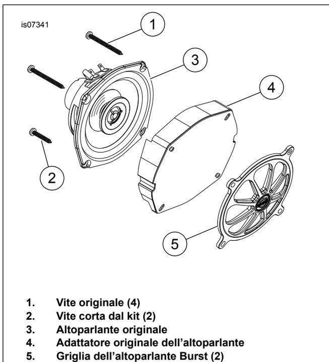
**Figura 1. Installazione dell'altoparlante originale (parte sinistra illustrata)**
