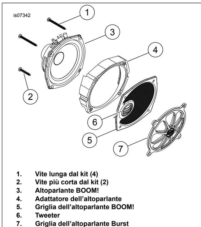
**Figura 2. Installazione dell'altoparlante BOOM! (parte di sinistra illustrata)**
