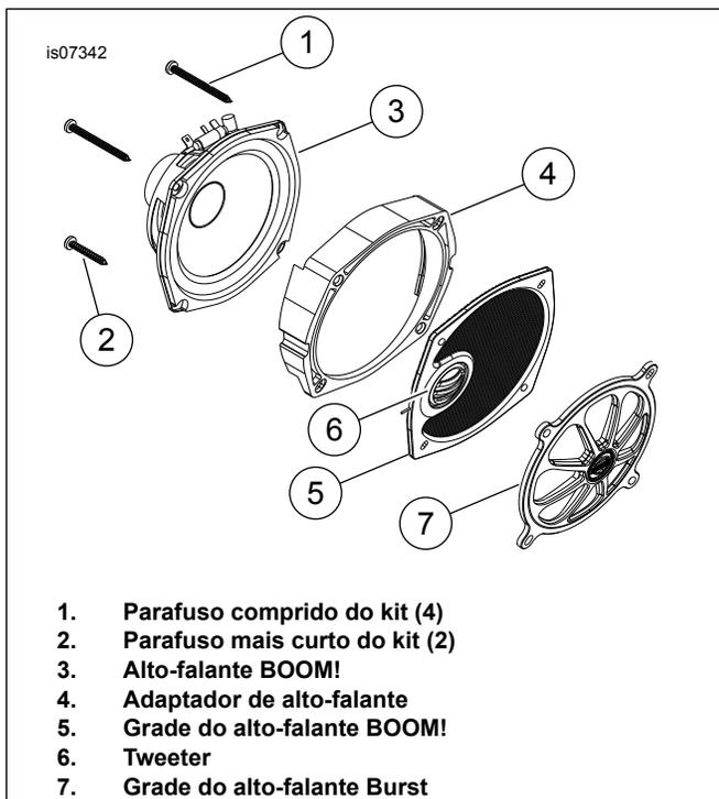
Figura 2. Instalação do alto-falante BOOM! (lado esquerdo mostrado)
