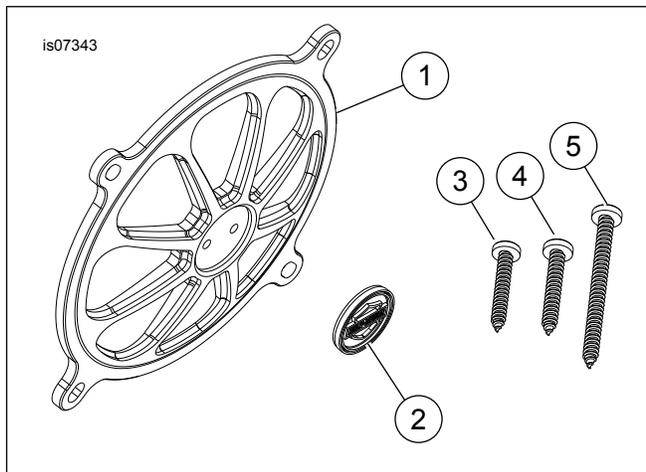
Figura 3. Peças de reposição: Grade do alto-falante coleção Burst
