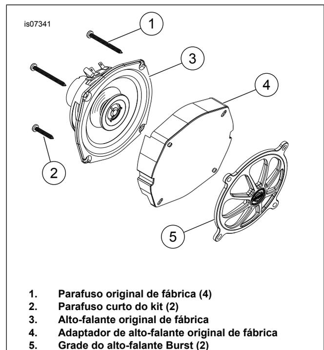
Figura 1. Instalação do alto-falante do equipamento original de fábrica (lado esquerdo exibido)
