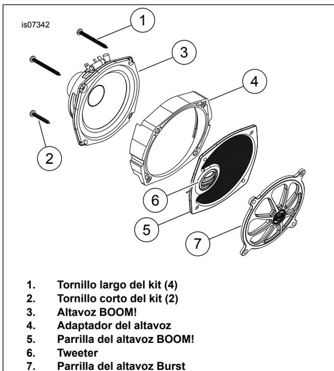
Figura 2. Instalación del altavoz BOOM! (se muestra el lado izquierdo)
