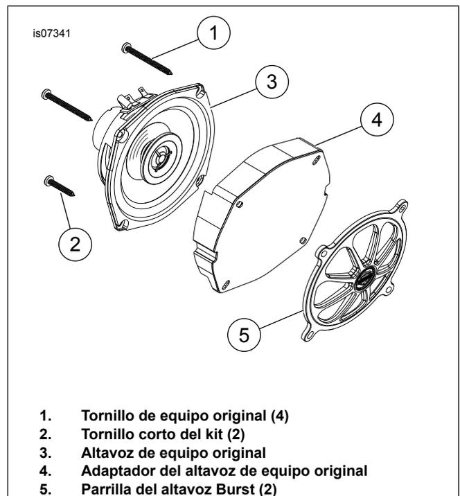
Figura 1. Instalación del altavoz de equipo original (se muestra el lado izquierdo)
