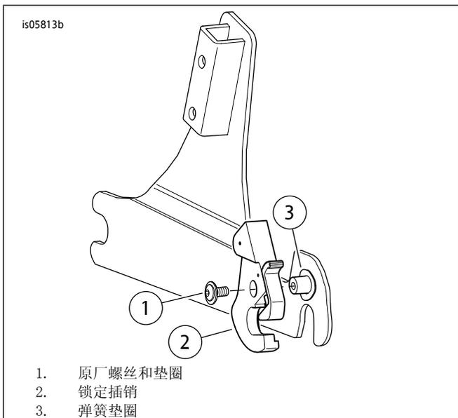
图7。内部右侧安装(隐藏式释放装置)
