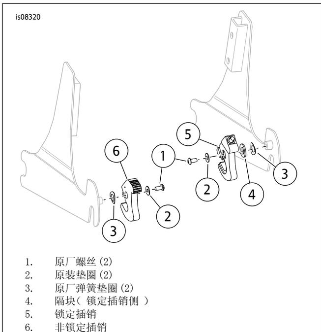
图8。内部右侧安装
