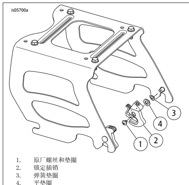
图5。内部右侧安装
