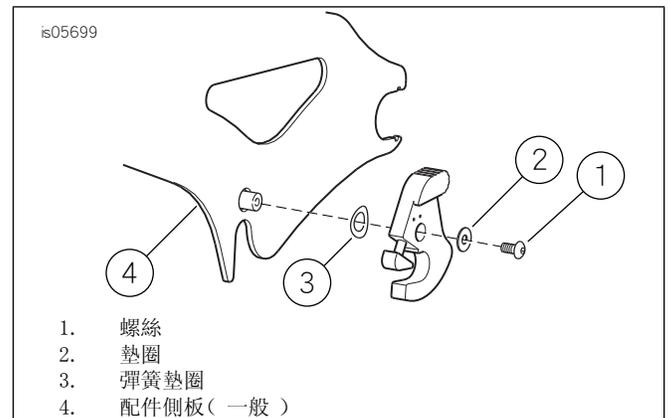
圖2。拆下門鎖（顯示外部右側安裝）
