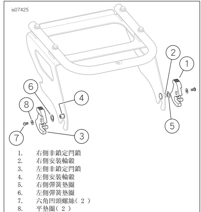
圖1。門鎖交換（顯示交換設定之前）
