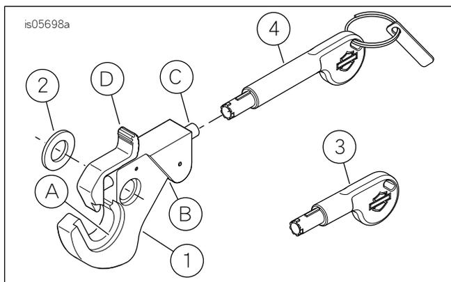
圖9。維修零件可拆卸鎖件工具包
