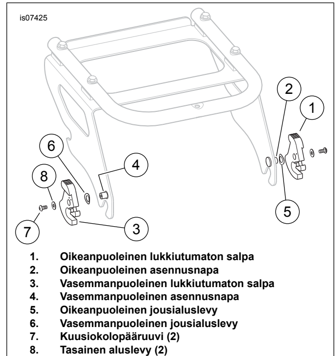
Kuva 1. Salvan vaihtaminen (vaihtoa edeltävä määräys kuvassa)
