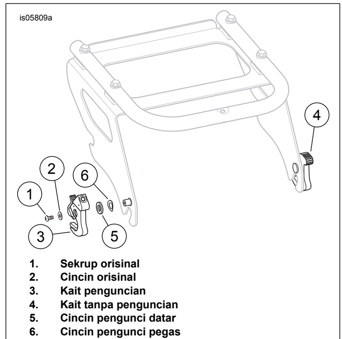
Gambar 4. Pemasangan di Kiri Luar
