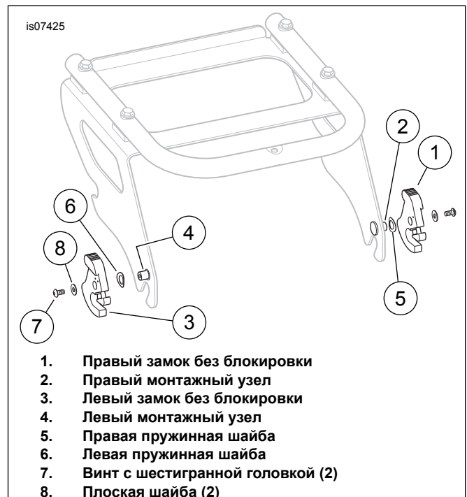
Рисунок 1. Замена замков (показана конфигурация до замены)
