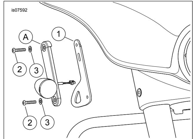
Figura 1. Instalación de la pieza de soporte de amarre
