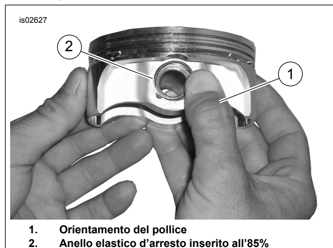
Figura 4. Installazione dell'anello elastico d'arresto
