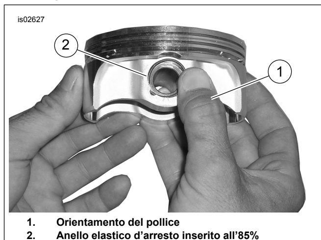
Figura 4. Installazione dell'anello elastico d'arresto
