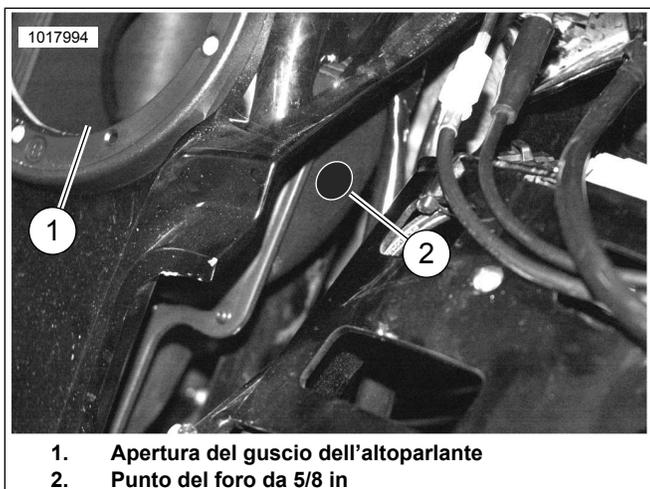
Figura 23. Punto di perforazione
