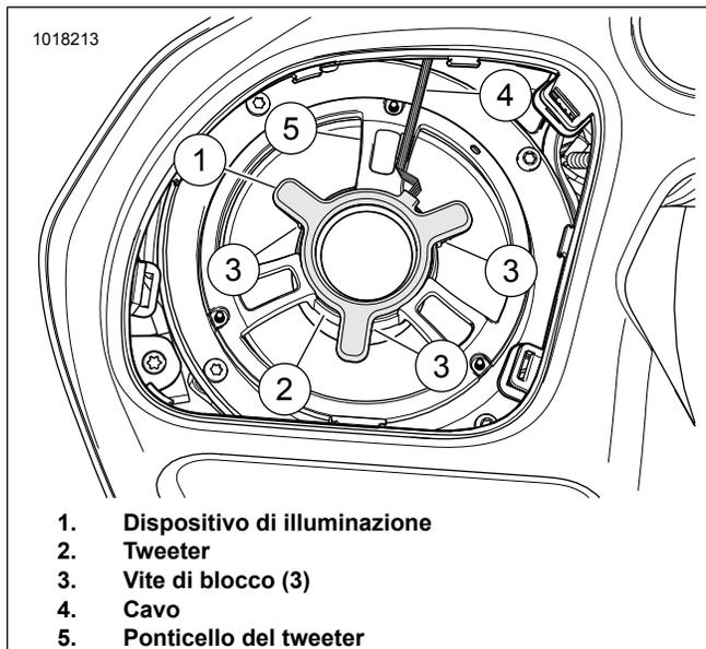
**Figura 8. Altoparlante della carenatura di sinistra FLTR**
