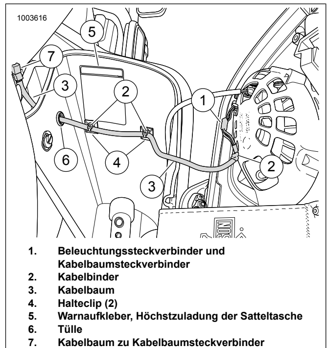
Abbildung 24. Satteltaschen-Kabelverlegung
