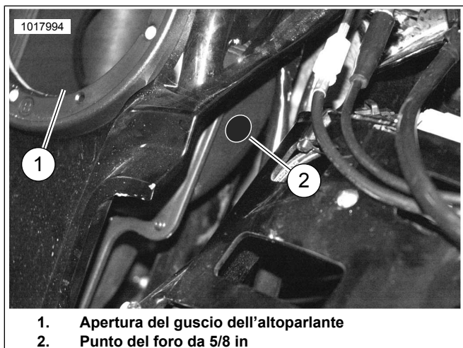
Figura 26. Punto del foro da 5/8 in con trapano
