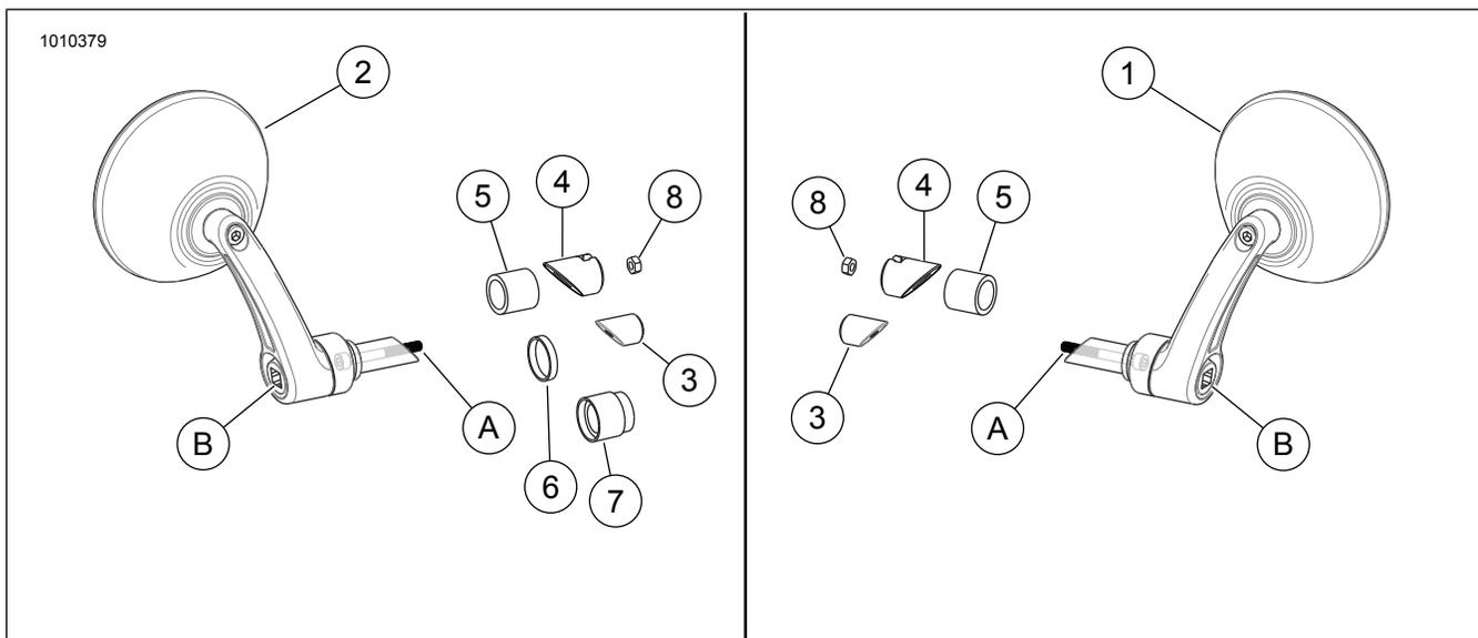
Figura 2. Peças de reposição: Kits de espelhos da extremidade da barra
