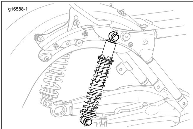
Figure 1. Orientation de l'amortisseur avec pièces amovibles P&A
