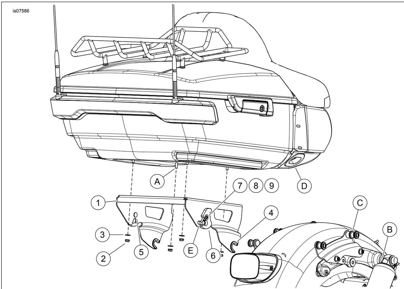
Figure 2. Pièces de rechange, porte-bagage Tour-Pak Solo amovible
