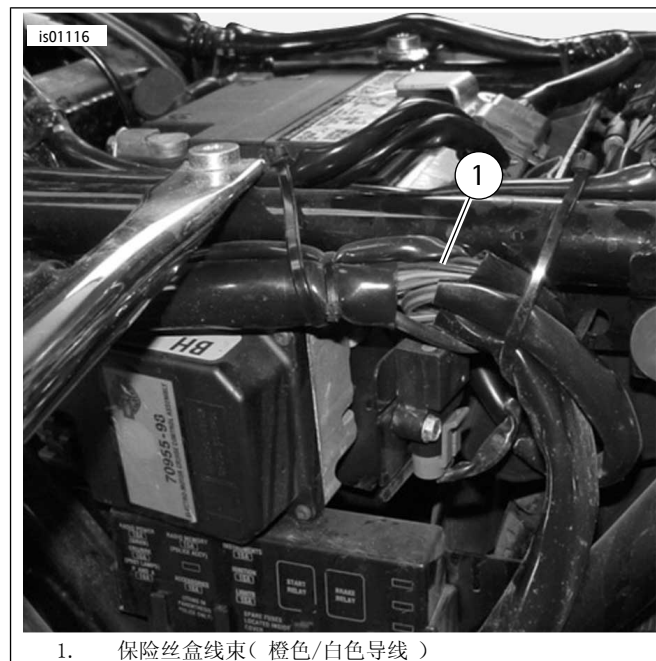
图12. 左侧盖后面的保险丝盒线束, 2003年款或之前旅行车型(图示为FLHTCUI车型)
