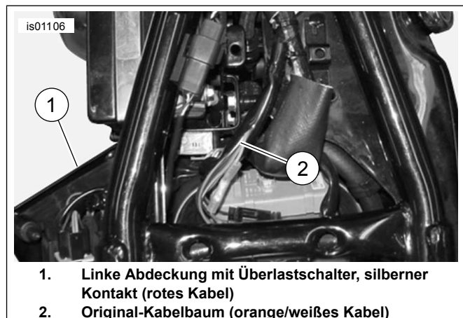
Abbildung 11. Stromanschlüsse (XL-Modelle)
